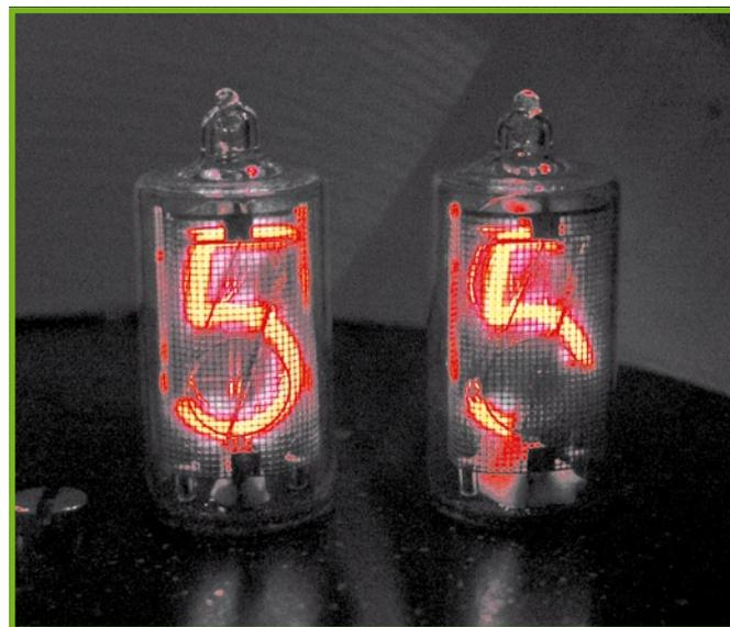
Elektronen bedeuten aber weniger Helligkeit. Auf diese Weise entstehen Ziffern, die stellenweise völlig ungleichmäßig ausgeleuchtet sind. Dieses Phänomen wird fachsprachlich als Kathoden-Vergiftung oder –Degradation bezeichnet.
